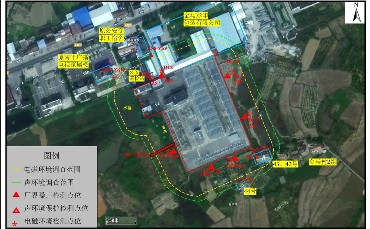
图 7-1 公安 220kV 变电站检测布点示意图
