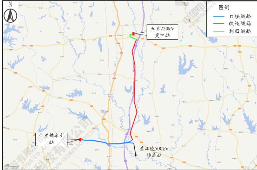
图 4-9 原江陵~五里 220kV 线路 \pi 入十里铺牵引站线路工程线路路径示意图
