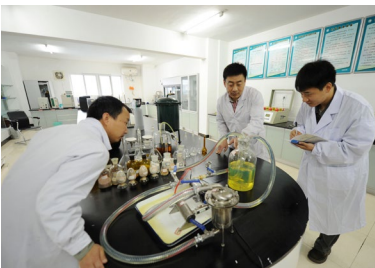
国网孝感供电公司劣化变压器油再利用
