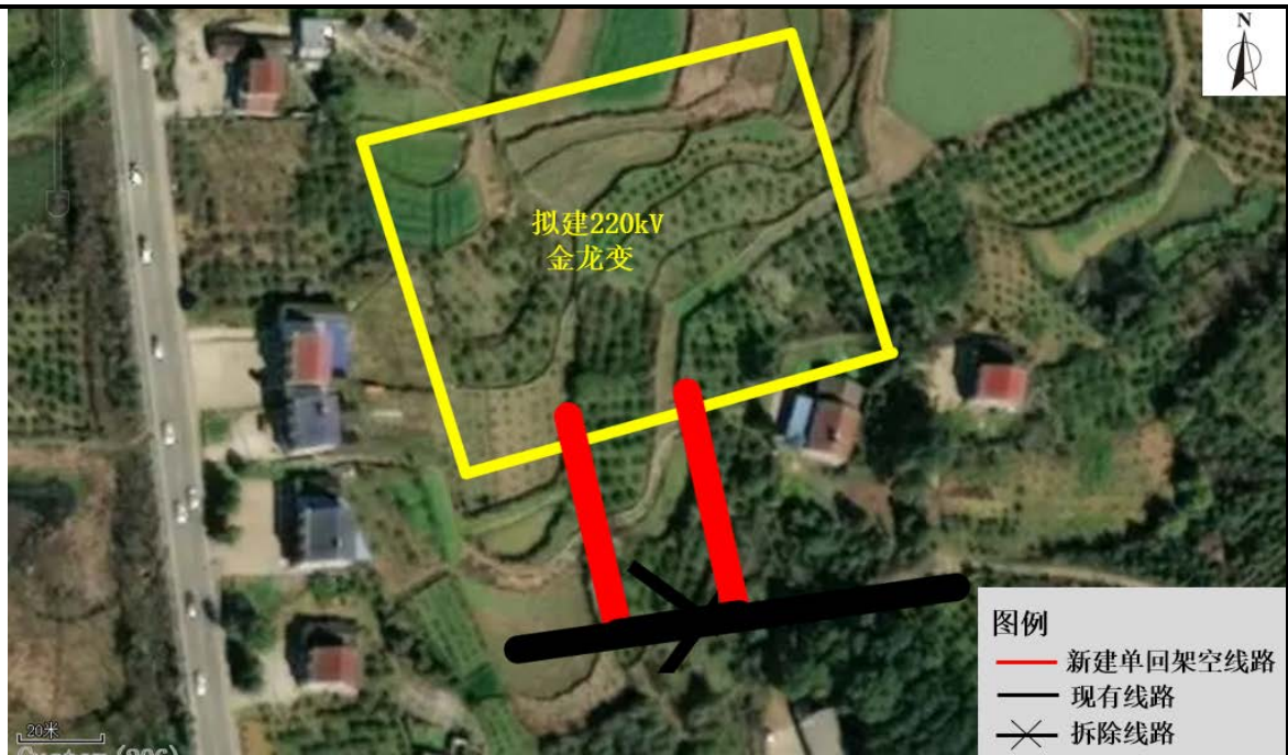
图 2-5 顾家店~工业园 1 号 II 回 110kV 线路 \pi 入金龙变线路路径走向示意图
